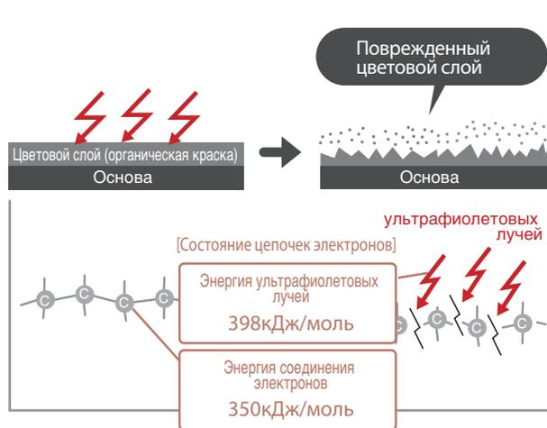
Энергия химических соединений покрытия панели меньше энергии ультрафиолета,
