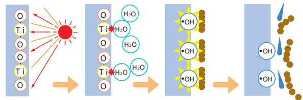
1. Фотокатализаторы  $TiO_2$  взаимодействуют с молекулами  $H_2O$ , содержащимися в воздухе
