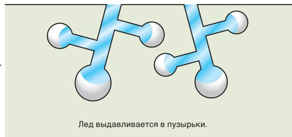
Пузырьки ослабляют давление, возникающее при замерзании воды, и тем самым защищают материал от разрушения
