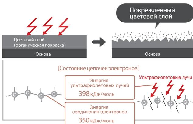
Поскольку энергия химических соединений фотокерамического слоя больше, чем энергия воздействия ультрафиолетовых лучей, соединения не только не разрушаются,
