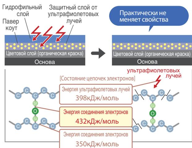
Поскольку энергия химических соединений гидрофильного покрытия больше, чем энергия ультрафиолетовых лучей, поверхность панели не только не разрушается,
