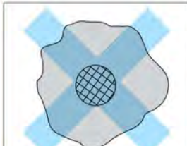
Ремонтная краска начнет отслаиваться, если площадь нанесения слишком большая.
